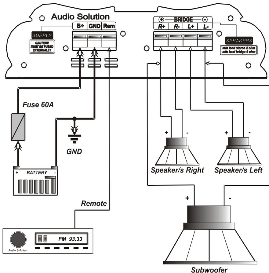
Lo schema rappresenta il classico collegamento per la sezione di potenza e viene rappresentata la configurazione tri-mode. Considerare i seguenti punti per garantire le massime performance in assoluta sicurezza:
