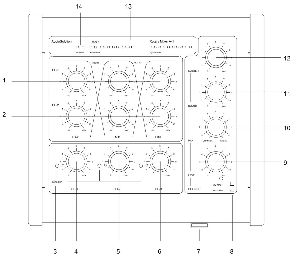
**1** – Il canale 1 (CH-1) è internamente suddiviso in 3 bande da un crossover puramente analogico, i potenziometri impostano il livello di ogni banda, il primo copre la banda da 10Hz a 320Hz, il secondo quella da 320Hz a 4200Hz ed il terzo quella da 4200Hz a 30000Hz. Questo controllo opera una particolare variazione della tonalità molto versatile.
